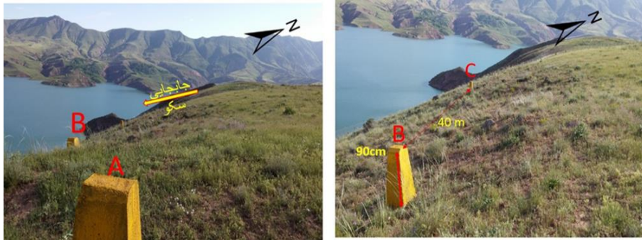
عکس ۴ جابجایی سکوه‌های پایش کنترل سطحی پیرامون سد (دامنه شمالی) از A تا C، ۱/۸۰ سانتی‌متر.
