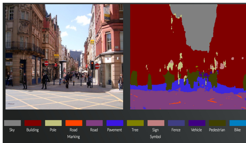
شکل ۵: یک نمونه قطعه‌بندی معنایی به‌وسیله‌ی Seg Net
