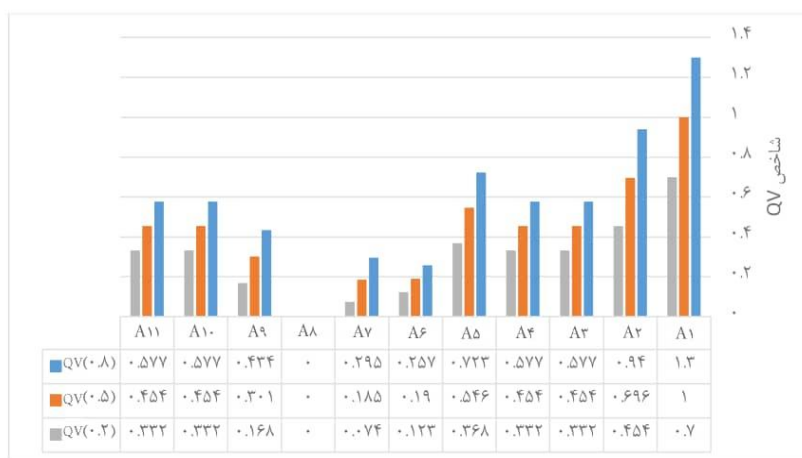
شکل ۳: نتایج ارزیابی ریسک سد مخرنی بالارود در فاز ساختمانی مطالعات پساارزیابی
