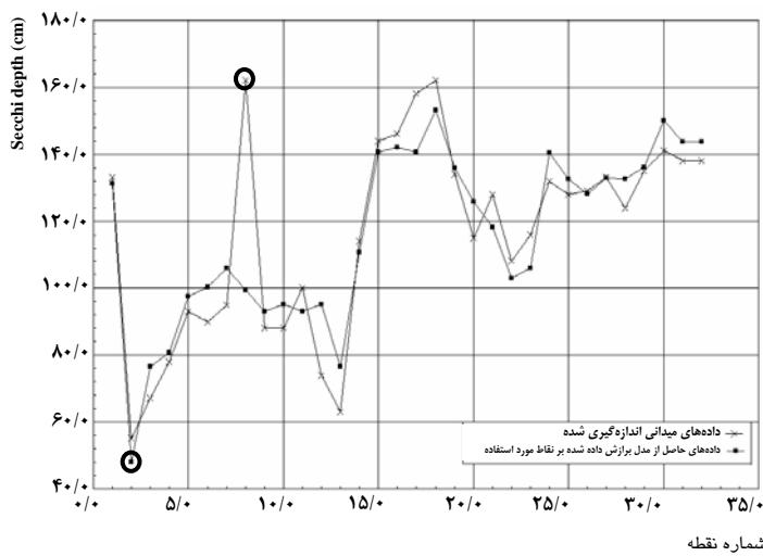
شکل ۶ مقادیر اختلاف بین داده‌های اندازه‌گیری شده و برآورده شده به وسیله فرمول ۱
