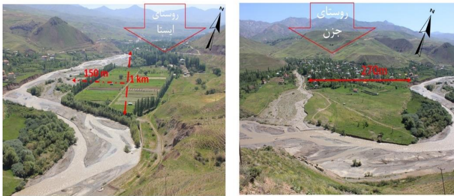
ب: تغییر مسیر رود در نتیجه دخالت عامل انسانی و گسترش پیچان رود در نتیجه احداث سد
