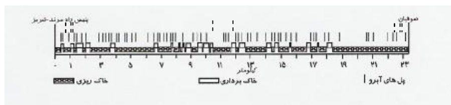
شکل 3 وضعیت عملیات خاکی در مسیر جاده و محل پلهای آبرو، خط‌چینها نشانگر محل آبراهه‌هایی هستند که بدون پل آبرو می‌باشند.
